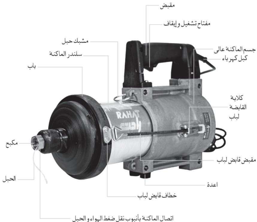
الحبل المستخدم في ماكينة سبرنج "راحت" الكهربائية لتوصيل الأساند
